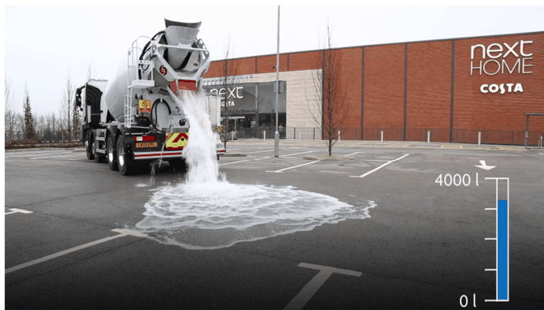
Figura 10 - Exemplo: Asfalto drenante da marca holandesa Lafarge Tarmac (Topmix Permeable), que absorve quatro mil m^3 de água por segundo e é indicado para garagens, ciclovias e bairros residenciais de baixo tráfego. (Fonte: galileu.globo.com)
